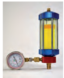
Kältemittel R134a gemischt mit - DENSO ND8 (PAG46) - UV-Lecksuchadditiv - Universalöl (PAO68)
